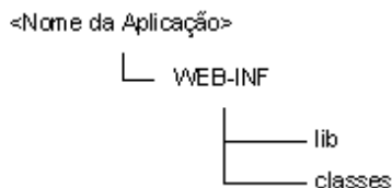
Figura 2.2 – Estrutura mínima de diretórios de uma Aplicação Web.
